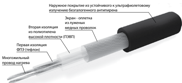
Конструкция кабеля нагревательного мата ELEKTRA SnowTec® Tuff
