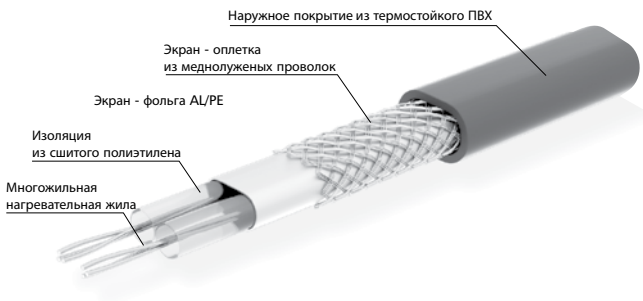
Конструкция нагревательного мата ELEKTRA SnowTec®
